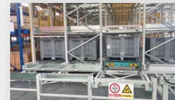
Vehículo lanzadera de cuatro direcciones
