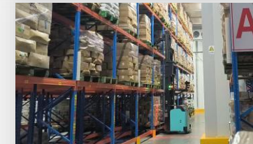
Recogida en doble profundidad a gran altura
